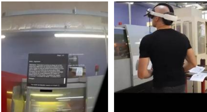
Fig. 3. Utilisation par le formateur de l'application XR. À gauche, une capture d'écran de la vue casque « passthrough » du formateur présentant l'interface utilisateur. À droite, la vue du formateur dans l'environnement lors de l'utilisation l'application XR. Le formateur a positionné l'interface utilisateur au-dessus de la machine, de manière à ne pas être gêné lors des tâches, tout en la gardant à proximité.
